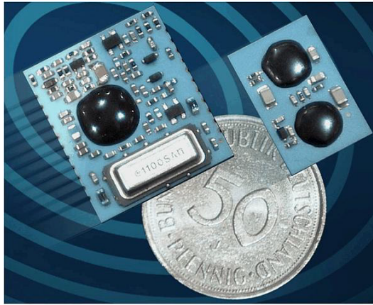
Die Chip-Technologie verfeinert sich. Hier ein Beispiel für die Miniaturisierung: Links ein aktuelles HF-Modul von National Semiconductor (LMX3162), rechts ein künftiges Komplett-Bluetooth-Modul.
